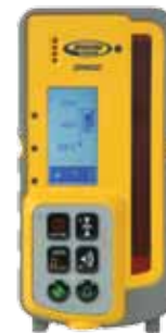
DR400 в режиме дальномера (луч излучается снизу, дисплей перевернут для удобного отсчета)
